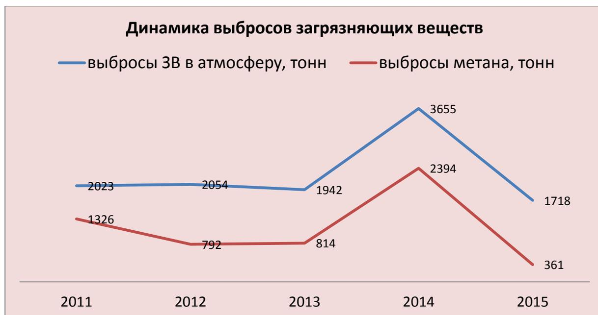
Основная масса выбросов метана (361,6 тонн) образовалась через продувочные свечи при продувке и опорожнении технологического оборудования УКПГ и газосборных коллекторов с целью проведения планово-предупредительных работ. Большое количество от валового выброса составляет оксид углерода – 694,508 тонн, оксиды азота, приведенные в перерасчете на NO<sub>2</sub> –
