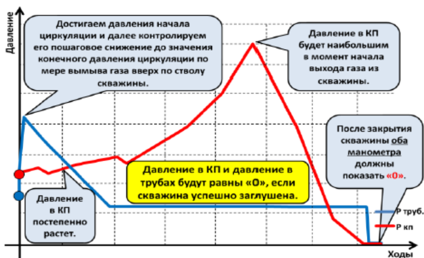
Рисунок 6. График изменения избыточных устьевых давлений в процессе использования метода «Ожидания и утяжеления»
