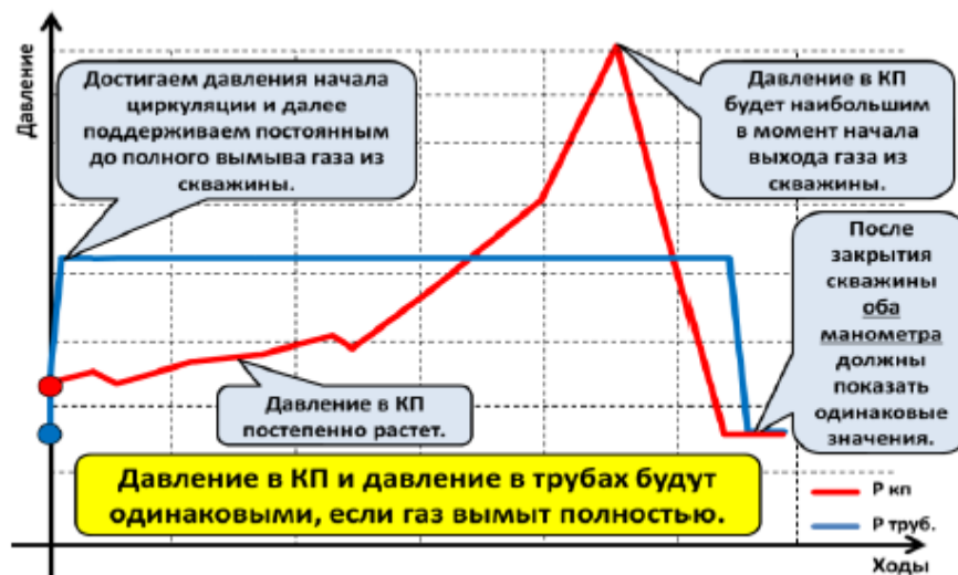
Рисунок 2. График изменения избыточных устьевых давлений в процессе использования первого этапа (циркуляции) методом «Бурильщика»
