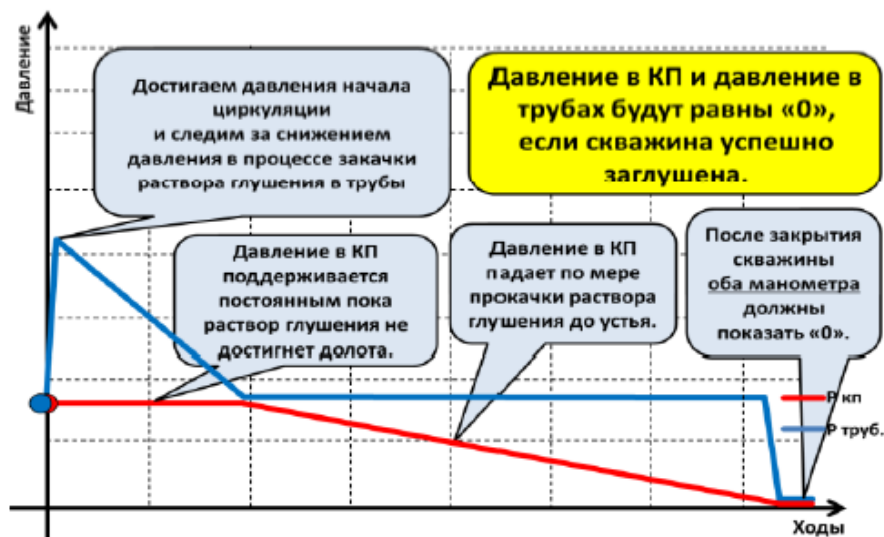
Рисунок 4. График изменения избыточных устьевых давлений в процессе использования второго этапа методом «Бурильщика»
